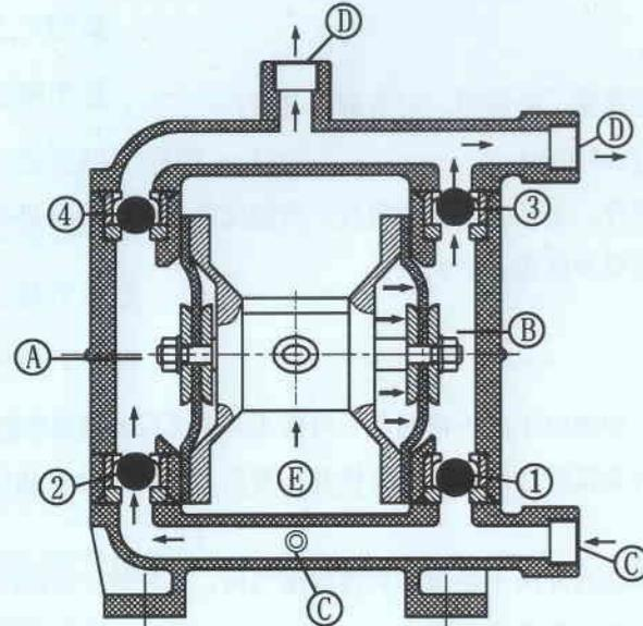
在泵的两个对称工作腔中①、②中各装有一块隔膜，由中心联杆将其连结成一体。压缩空气从泵的进气口进入配气阀，通过配气机构将压缩空气引入其中一腔，推动腔中隔膜运动，而另一腔中气体排出。一旦到达行程终点，配气机构自动将压缩空气引入另一工作腔，推动隔膜朝相反方向运动，从而使两个隔膜连续同步地往复运动。
